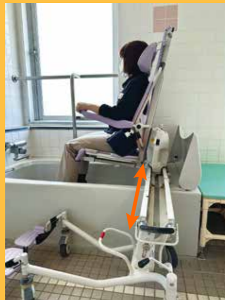
▲専用のバスタブにレールを設定。シャワーキャリーをレールに接続、浴槽上にスライドさせる
